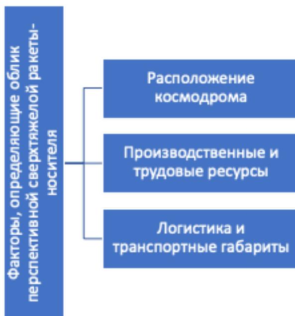
Логистика и транспортные габариты: создание сверхтяжёлых ракет-носителей может потребовать использования корпусов большого диаметра, превышающих существующие железнодорожные габариты. Важно что габариты грузов на главных российских магистралях, ведущих на Дальний Восток ограничены размерами железнодорожных тоннелей. Высокая цена доставки и жесткие ограничения габаритов может стать существенным сдерживающим фактором.
